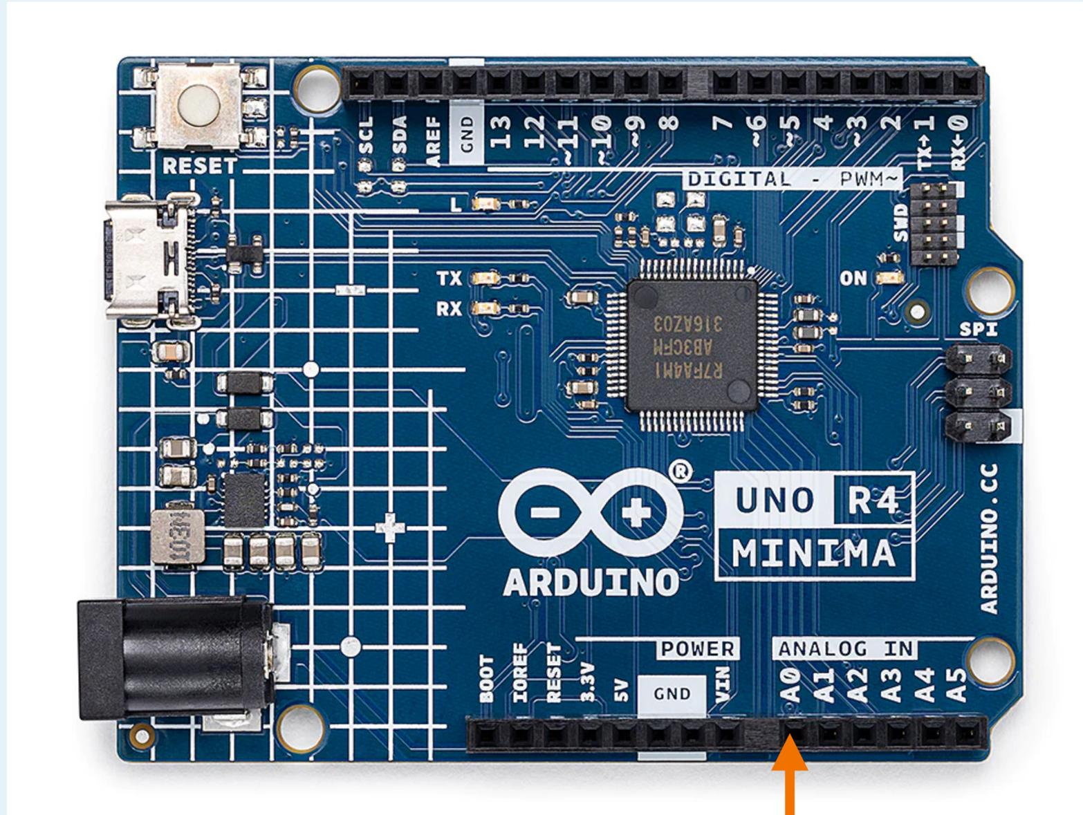
Arduino Uno R4はA0のピンにDAC(Digital-to-Analog Converter)がついている
