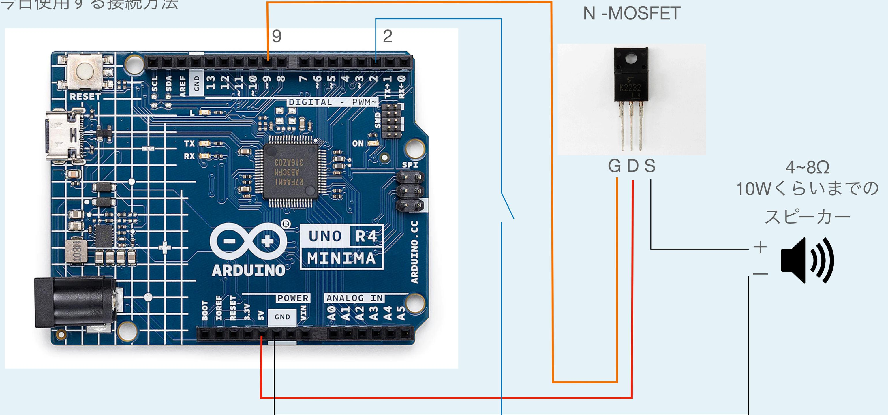
※簡易的な接続のため、直流成分が常にGNDに流れっぱなしになる。
